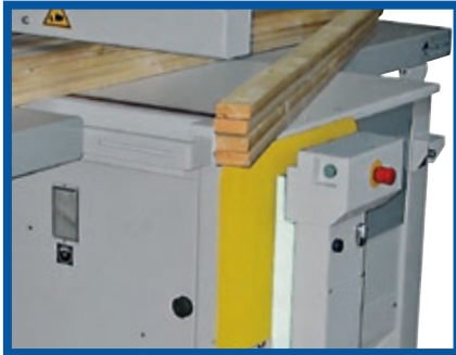
Schutzschild pneumatisch heb-/senkbar (Option) Ermöglicht ungehinderten Zugriff auf das Werkstück. Mit integriertem Sicherheitsschalter.
